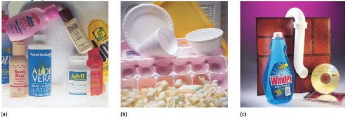
Figura 1. Productos de consumo común. a) Material de empaque de polietileno de alta densidad; b) objetos hechos de poliestireno, c) cloruro de polivinilo. La información sobre reciclado se incluye en la mayoría de los plásticos (generalmente extruida en el fondo del recipiente). El polietileno de alta densidad se designa por un “2” dentro de un símbolo triangular y las letras “HDPE” por sus siglas en inglés. El PVC se determina por un “3” dentro de un símbolo triangular y la letra “V” debajo.
